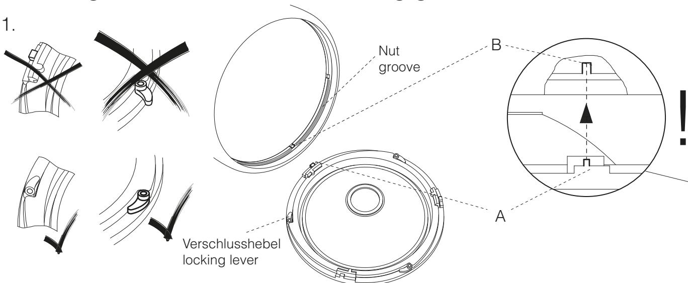
Nase A muß in der Vertiefung B liegen, damit die Verschlusshebel in die Nut im Leuchtenkopf eingreifen können.
