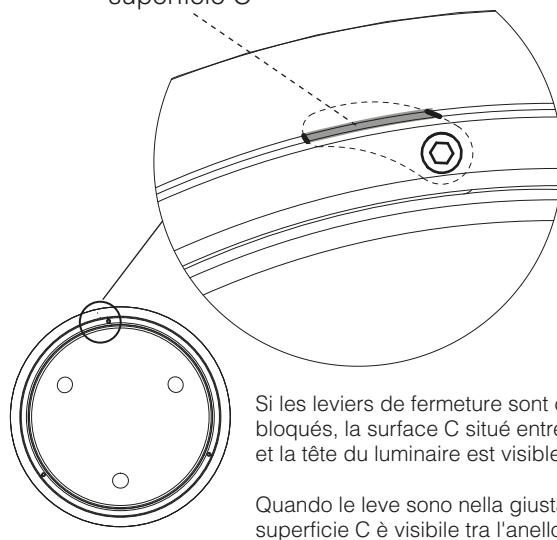
Si les leviers de fermeture sont correctement bloqués, la surface C situé entre l'anneau noir et la tête du luminaire est visible.
