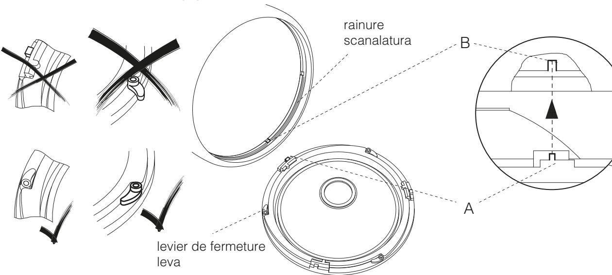
L'élément A doit s'encastrer dans l'encoche B afin que les leviers de fermeture puissent s'emboîter dans la rainure de la tête du luminaire. Tant que le verre du luminaire bouge, il n'est pas correctement monté.
